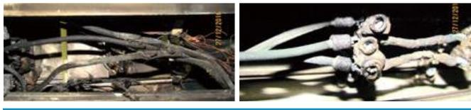
3) Admite-se que o sinistro teve foco próximo à área de tomadas elétricas (abaixo do painel), porém não se originou de curto-circuito, pois o calor no isolamento dos fios demonstra que veio de fora para dentro do fio.
