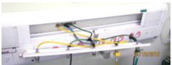
Foto 9 – Observam-se tubos flexíveis e os fios derretidos, todos no mesmo compartimento. No compartimento de cima os engates rápidos e fios azul e amarelo estão intactos.
